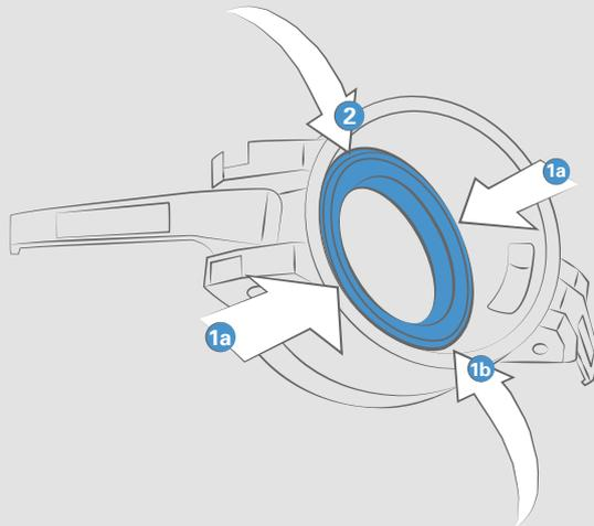
**Schritt 1:** Zum Einbau wird die Dichtung leicht zusammengedrückt (1a) und mit einer Seite in die Nut eingeführt (1b).
