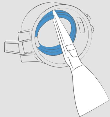
Zum Entfernen wird die Dichtung an einem Ende mit einer handelsüblichen Spitzzange angehoben und über ein leichtes Abknicken über die Mitte herausgezogen.
